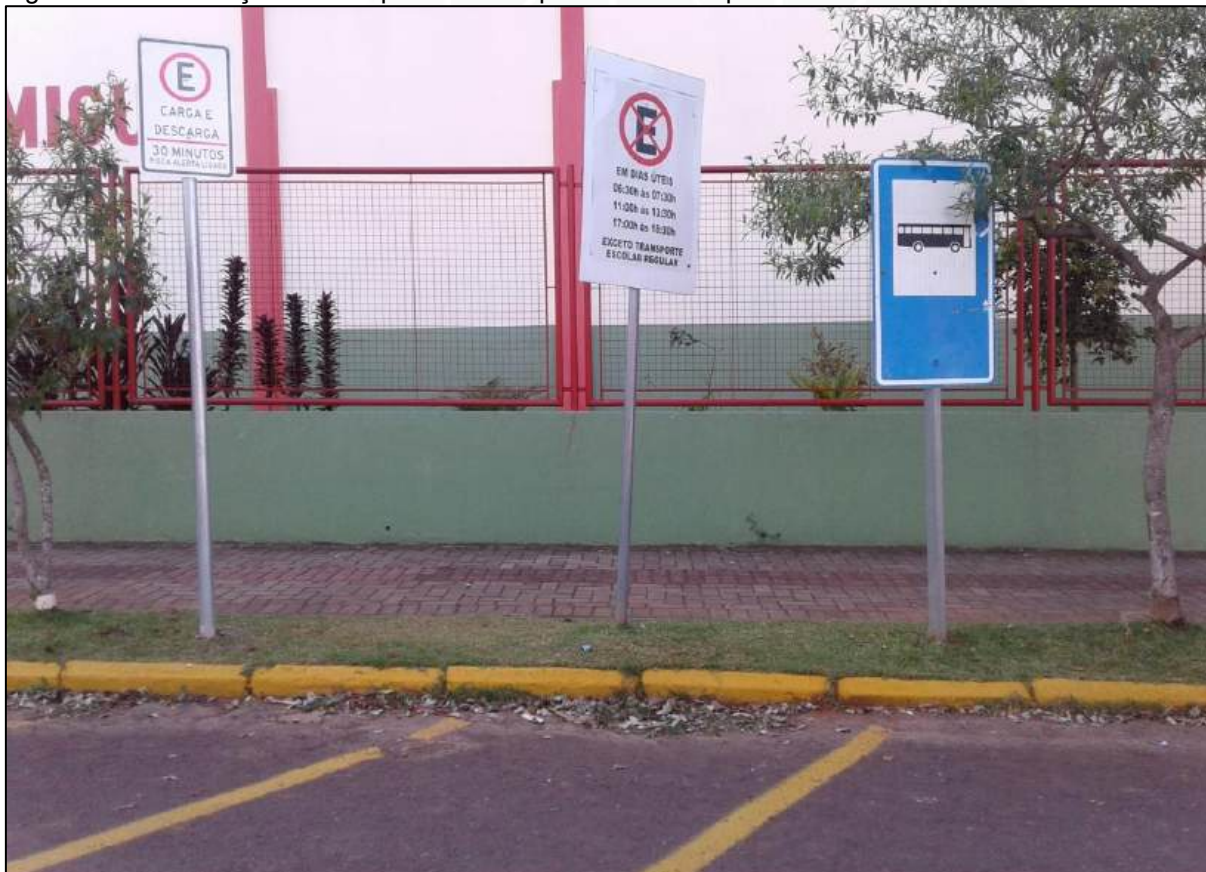
Figura 81 – Sinalização vertical para área de parada do transporte escolar
